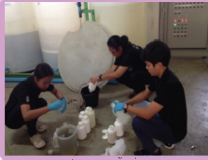
ทำการเก็บตัวอย่างน้ำเพื่อตรวจสอบ ประสิทธิภาพการทำงานของระบบ
